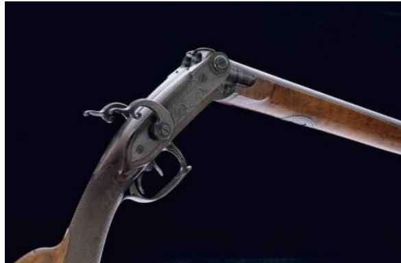
Fusil de Samuel Johan Pauly 1812 (armurier parisien d'origine suisse, avec la collaboration de François Prélat) avec 2 « faux chiens » extérieurs servant à l'armement des percuteurs internes appelés « pistons » par Pauly.
