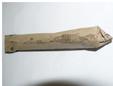
Cartouche en papier de fusil réglementaire Français (la balle ronde en plomb est dans la partie avant de la cartouche devant la poudre)
